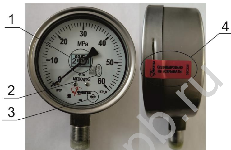
Рисунок 4 – Места нанесения знака поверки (1), заводского номера (2), знака утверждения типа (3) и защитной пломбировки (4)
